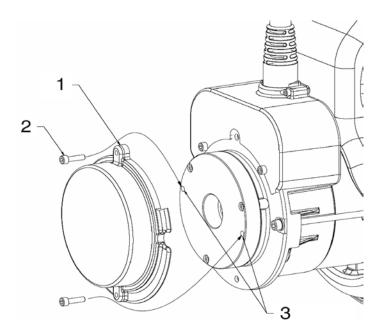
Figure 4-6. Manual Disengage
