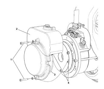
Figure 4-5. Manual Disengage
